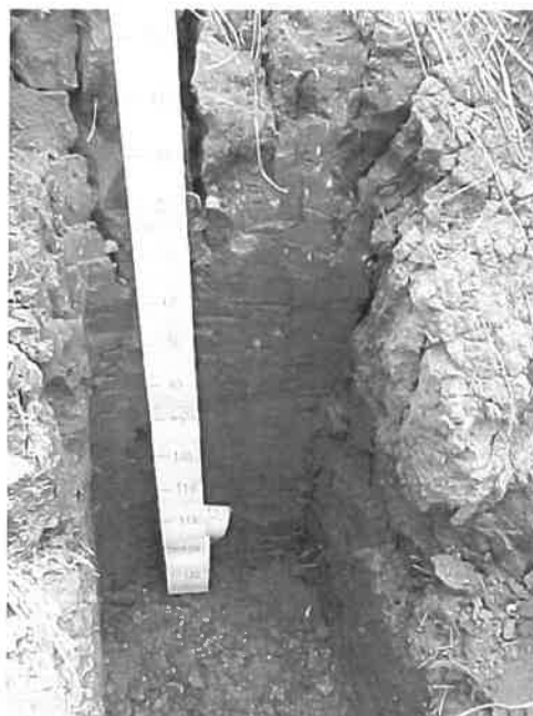
รูปที่ 4 ลักษณะการเปิดบ่อสำรวจดิน
