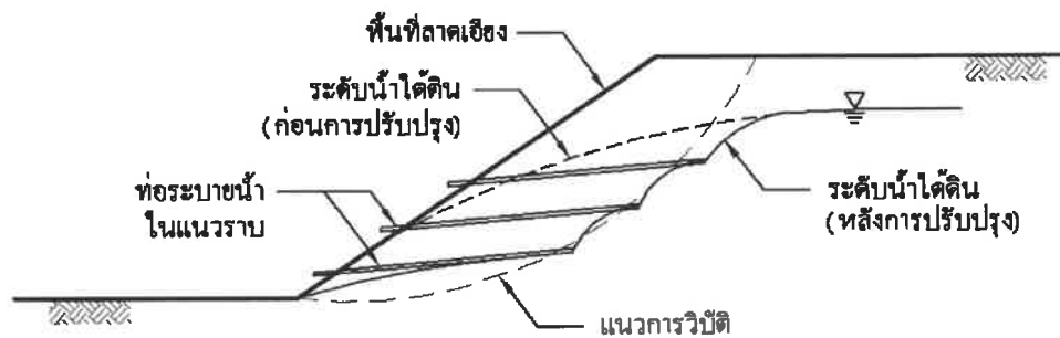
รูปที่ 28 ตัวอย่างการใช้ท่อระบายน้ำในแนวราบ (ข้อ 4.1.6(2))
