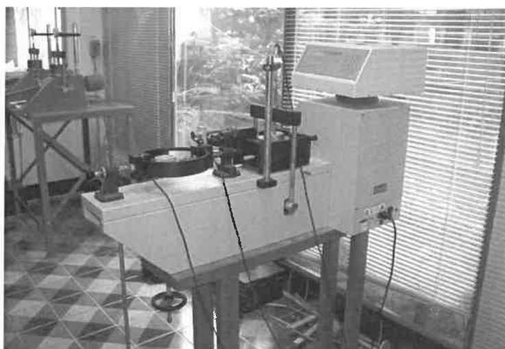
รูปที่ 8 เครื่องทดสอบ Direct Shear Test
