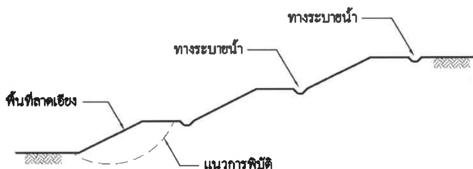
รูปที่ 13 ตัวอย่างทางระบายน้ำบนพื้นที่ลาดเอียง
